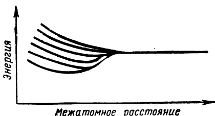
Рис. 2.11. Расщепление уровней при сближении атомов
